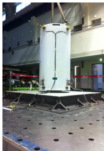
콘크리트 저장용기모델(철판베드부착모델) 콘크리트패드 vs. 철판패드
